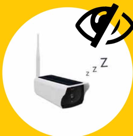
2. Quando se deteta movimento no campo de deteção, a câmara ativa-se de forma automática, iniciando-se assim a gravação e envio de alertas para o Smartphone previamente configurado.
